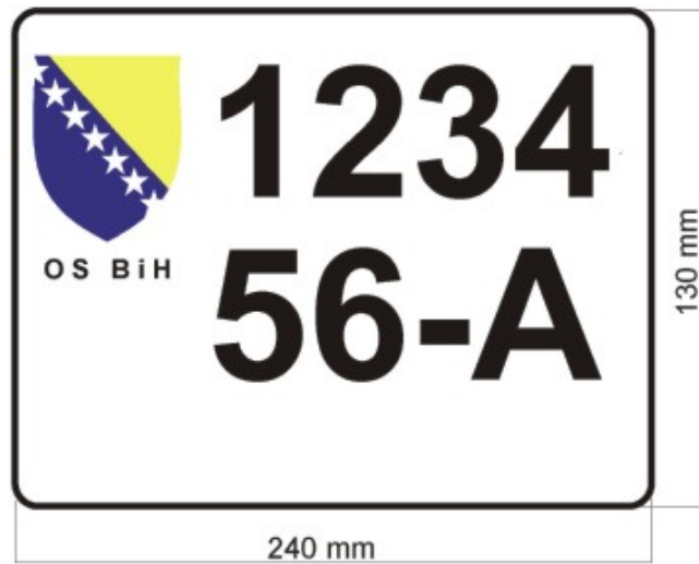
Izgled tablice, dimenzije 240 mm x 130 mm x 1 mm
